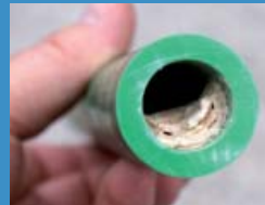
Ablagerungen bilden sich auch in Kunststoffrohren
