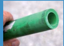
Ablagerungen bilden sich auch in Kunststoffrohren
